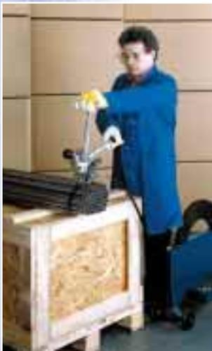
Cet appareil manuel facile à utiliser permet, selon le modèle, le cerclage de feuillards acier d'une largeur de 10 - 19 mm avec une
