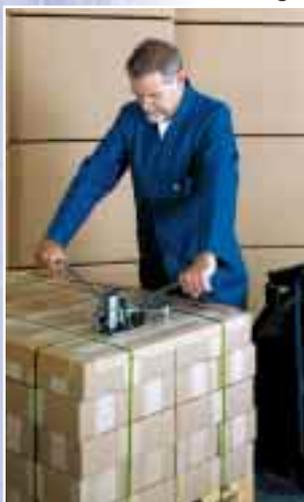
Das Umreifungsgerät für PET-Bänder mit 13 und 16 mm Stärke, schneidet spannungs- und damit spleißfrei.
