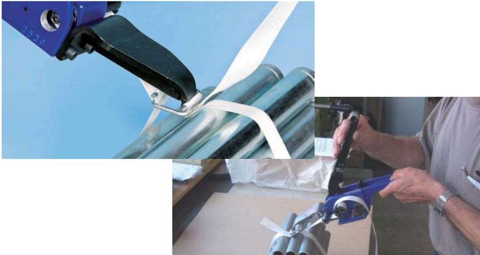
**Das speziell für den ManuCord MRC entwickelte Zubehör ermöglicht auf einfache Weise alle Packstücke, die keine beziehungsweise nur sehr geringe Standfläche für das Verschlussgerät haben, schnell und zuverlässig zu umreifen.**
