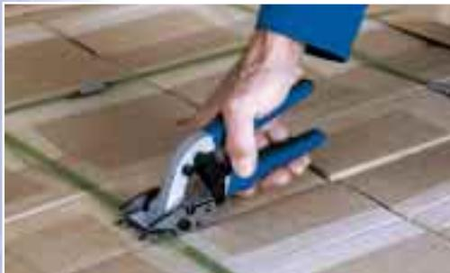
daß sie mit zwei Schneiden rechts und links an der Verschlußhülse ansetzt, das Band zerschneidet und die Verschlußhülse zwischen den Schneiden behält. Das spart Zeit und Geld!
